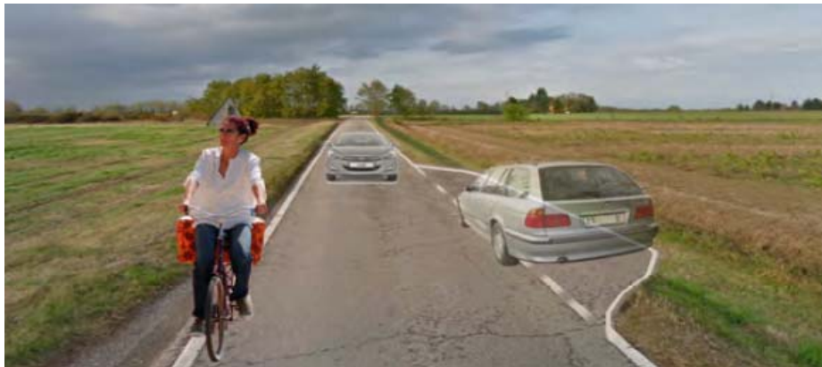
Fotoinserimento delle "piazzole di scambio" previste dal vigente PGT di Mediglia lungo la strada di accesso alla C.na Bruzzano (Fonte Scheda S10 del Piano dei Servizi del vigente PGT)
